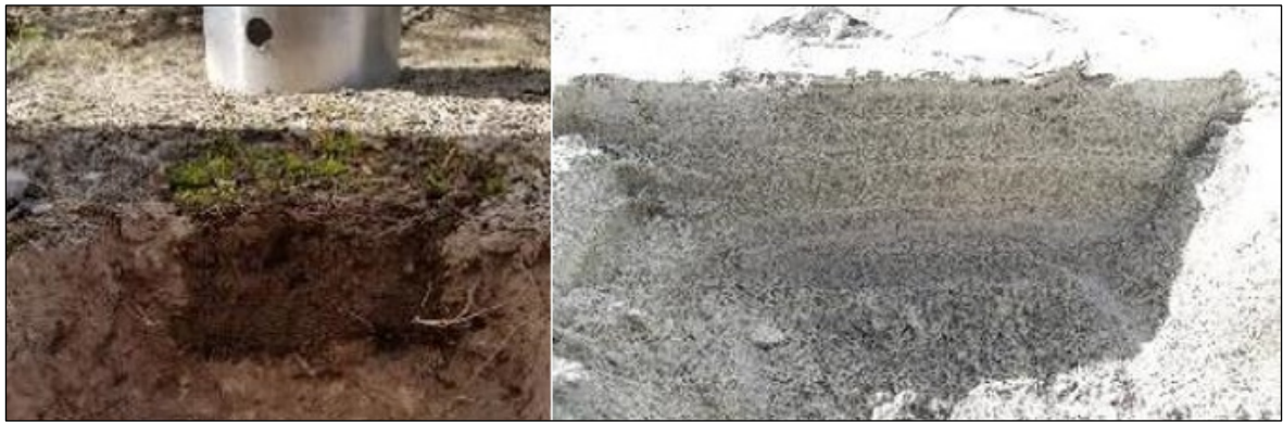
Figura 25. Perfil de infiltración en horizonte A de suelo aguas arriba de la presa de jales (izq) y perfil sin definición en jales mineros (der)
