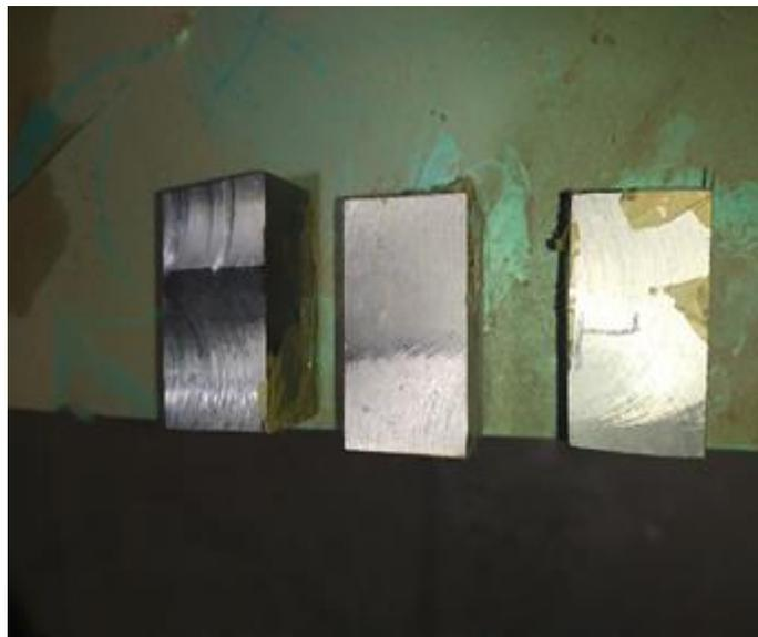
**Figura 4.** *Lingotes, homogeneizados, cortados y maquinados con medidas de 3.5 cm x 4.2 cm x 5 cm.*
