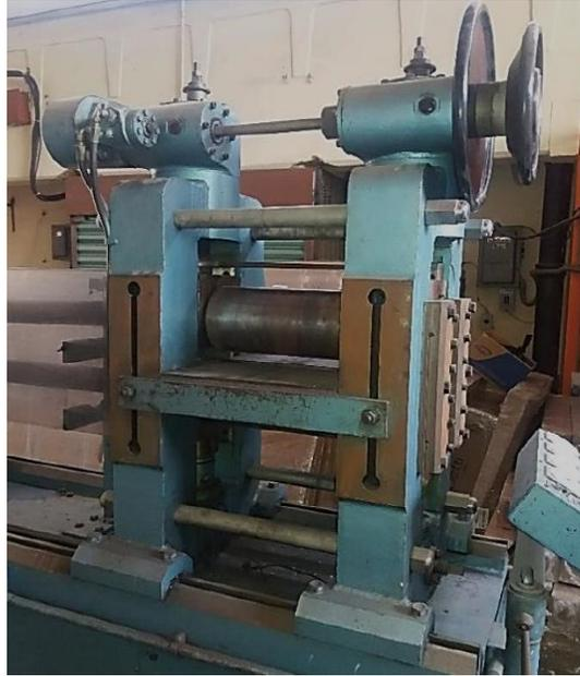
**Figura 5.** Molino de laminación Hille Helicon Mk4.
