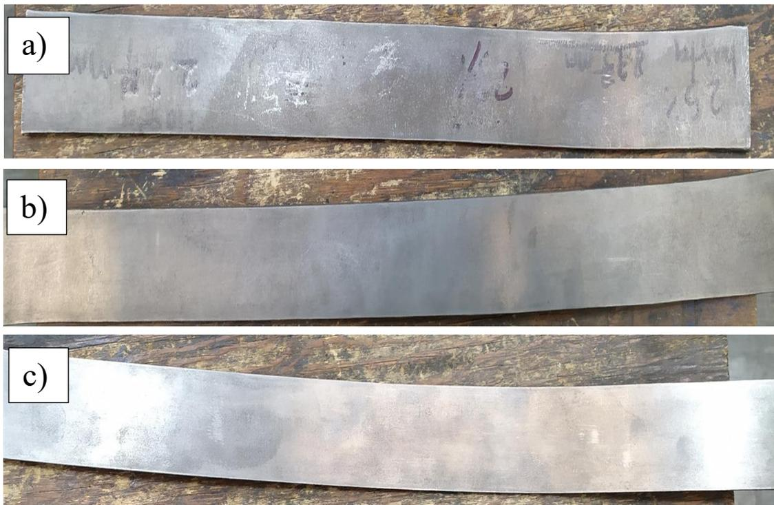
**Figura 7.** Acero laminado en frío con distinto grado de reducción en espesor: a) 2.27 mm (25 % de reducción), b) 1.75 mm (40 % de reducción), c) 1.22 mm (60 % de reducción).
