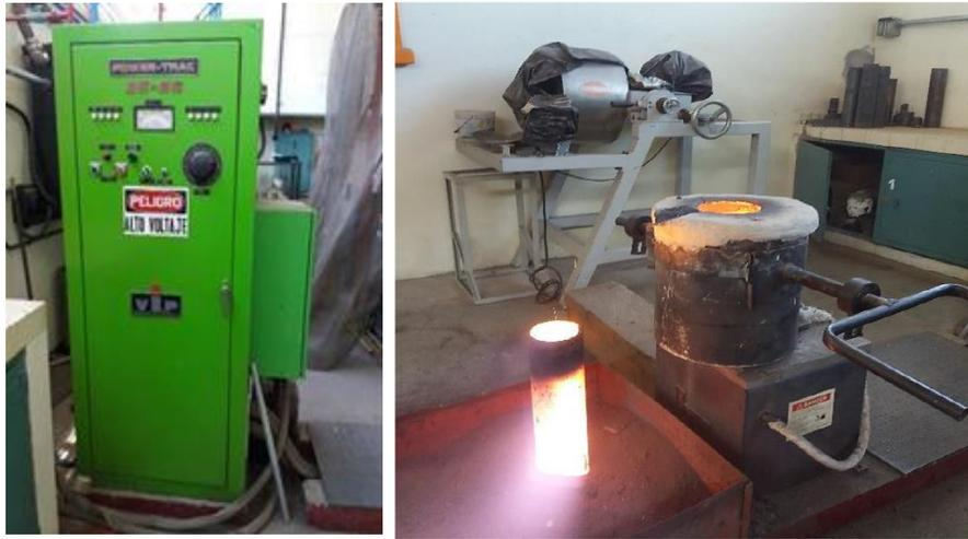
*Figura 2. Horno de inducción Power-Trak 35-96.*
