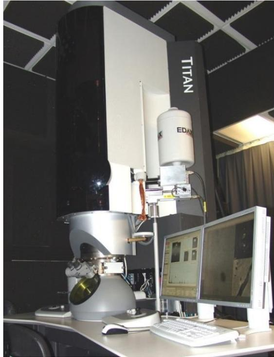
**Figura 23.** Microscopio electrónico de transmisión marca FEI modelo TITAN 80 – 300 kV.
