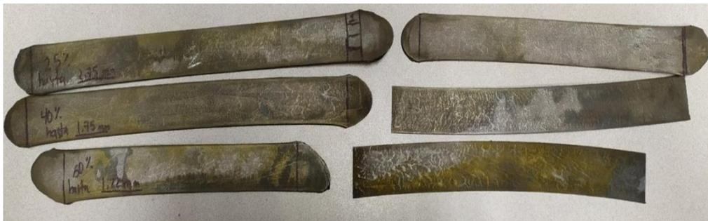
**Figura 6.** Acero laminado en caliente hasta 3 mm de espesor.
