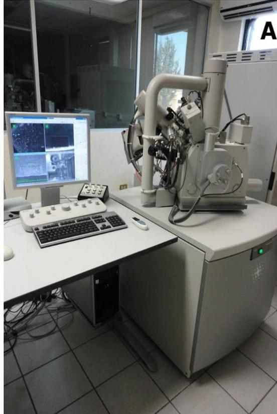
**Figura 17.** Estación de trabajo Dual Beam marca MEB/FIB QUANTA 200 3D.
