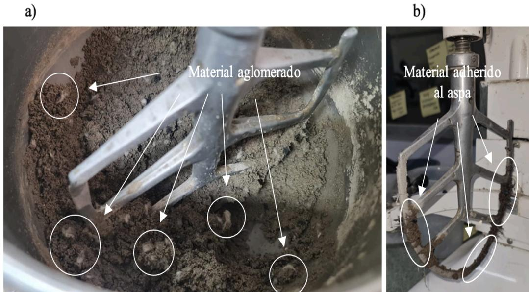
*Fig. 16. Mezcla de morteros con adición de DLA. a) DLA aglomerado en la mezcla. b) DLA adherido al aspa del mezclador mecánico.*
