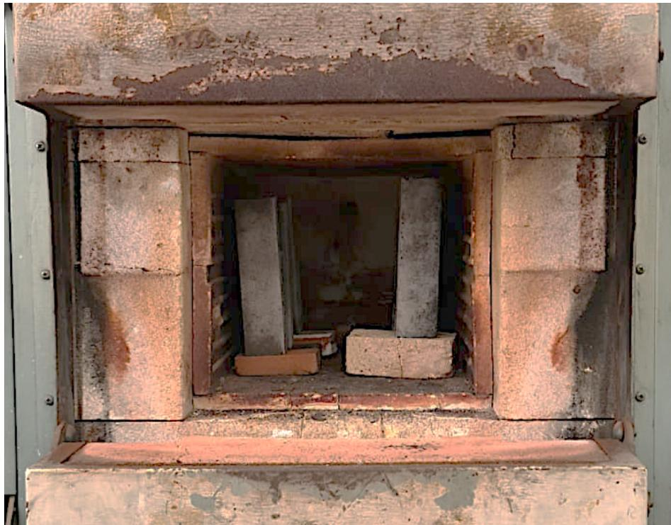
*Fig. 19. Probetas en mufla para ensayo a elevadas temperaturas.*
