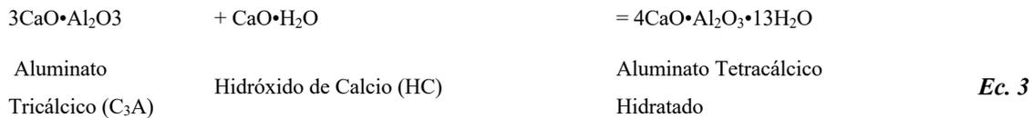
En la Ec. 3 el aluminato tricálcico reacciona con los hidróxidos de calcio para formar aluminato tetracálcico hidratado con una tasa de reacción muy rápida.
