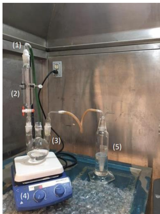
Figura 16. Sistema experimental empleado en pruebas de acidificación y volatilización de HCN. 1) Inyección de gas, 2) Dosificador de soluciones, 3) Matraz de tres bocas, 4) Controlador de agitación, 5) Recipiente Dreschel.
