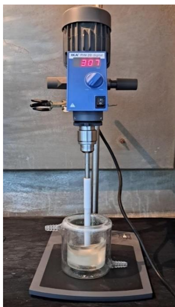
Figura 13. Sistema para la disolución de las piezas con contenido de oro.
