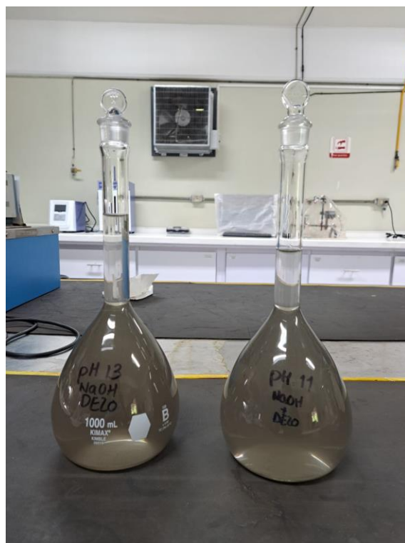
Figura 53. Soluciones con concentración de 15 000 ppm GDA, izquierda con un pH= 13 y derecha con un pH= 11
