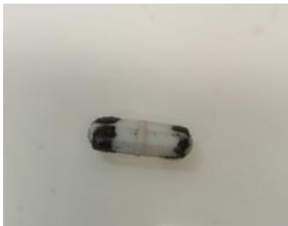
Figura 52. Barra magnética con partículas negras (Fe) adheridas.
