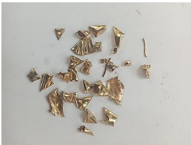
Figura 12. Piezas metálicas con contenido de Au, previo a su disolución en solución de cianuro.
