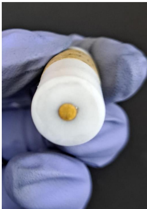
Figura 30. Electrodeposición de oro en electrodo de acero inoxidable 316.
