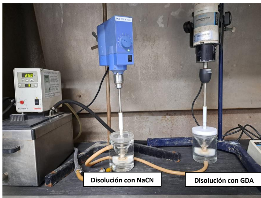
Figura 15. Sistema experimental empleado en pruebas de cinética de disolución de oro.
