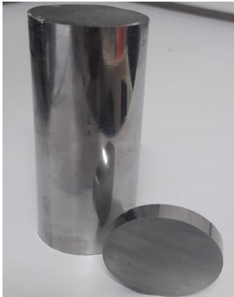
**Figura 13.** Barra de acero AISI 1015 utilizada como material base para la obtención del acero experimental.
