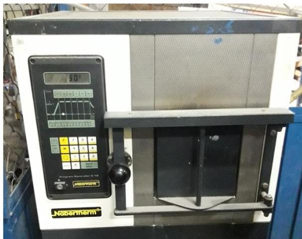
**Figura 15.** Horno de mufla Nabertherm.
