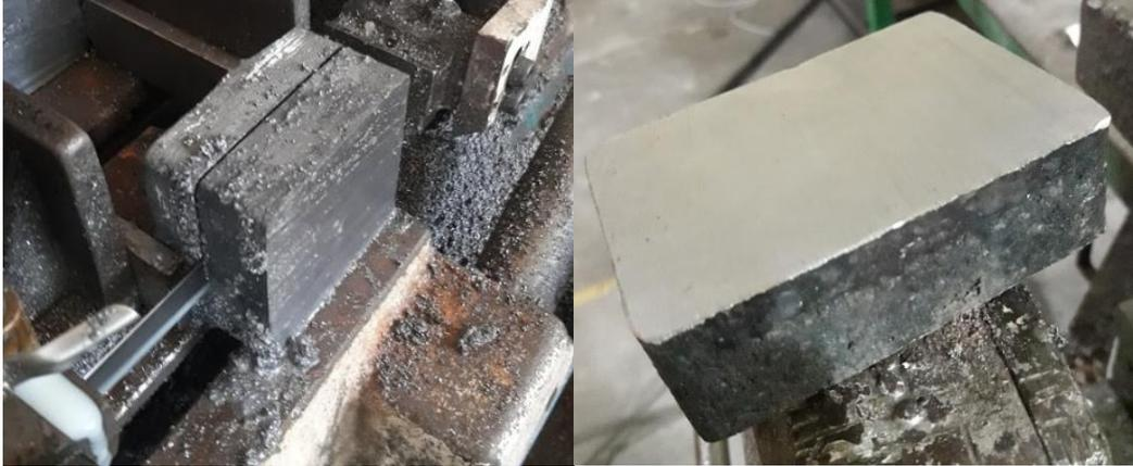
**Figura 16.** Probetas obtenidas para el proceso de laminación en caliente.
