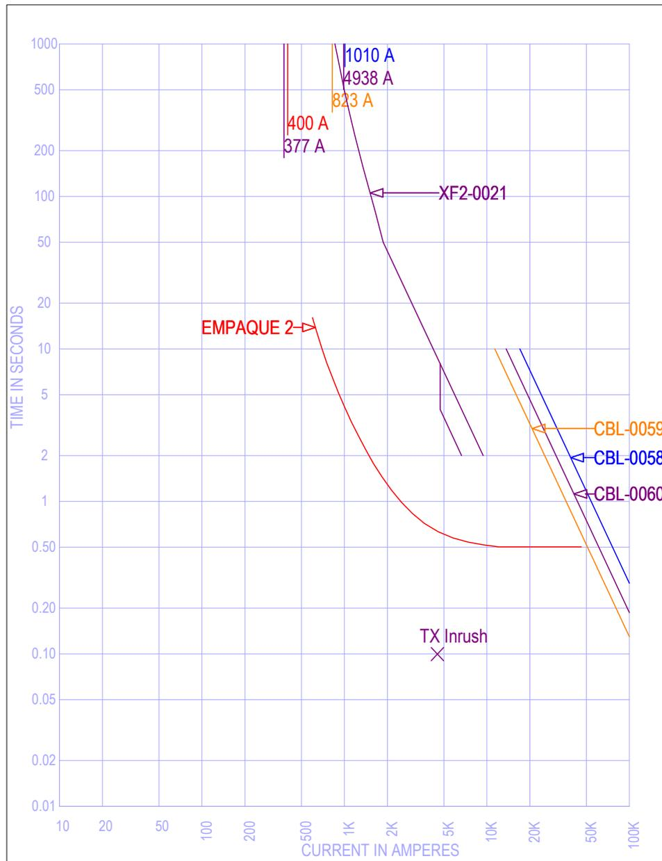
Figura 3.29: TCC de protecciones de fase en zona de protección empaque 2, tensión de referencia 2.4 kV.
