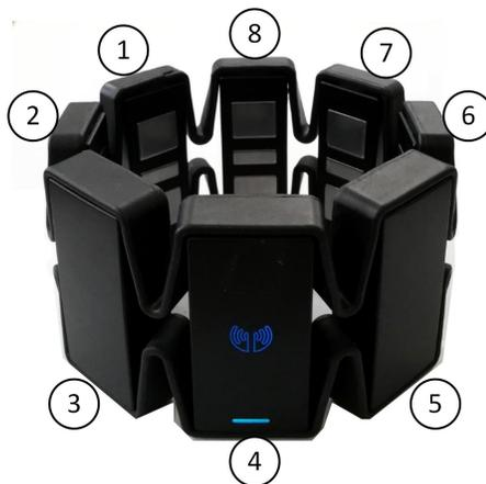
**Figura 4.3.** Ubicación de los sensores del brazalete MYO Gesture Control Armband.
