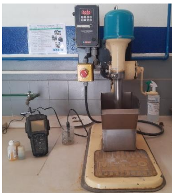
Figura 38. Celda de flotación Denver (METSO D12V-044).
