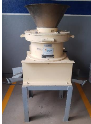
Figura 28. Trituradora ternaria de cono convencional (CC).
