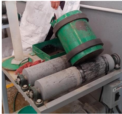
Figura 36. Molino de bolas utilizado en las pruebas de cinetica de molienda.
