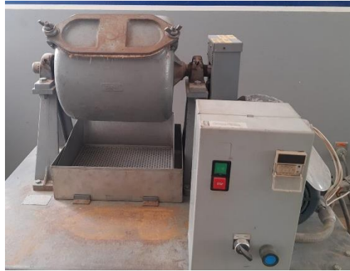
Figura 35. Molino de Bond utilizado para realizar pruebas de W_i .
