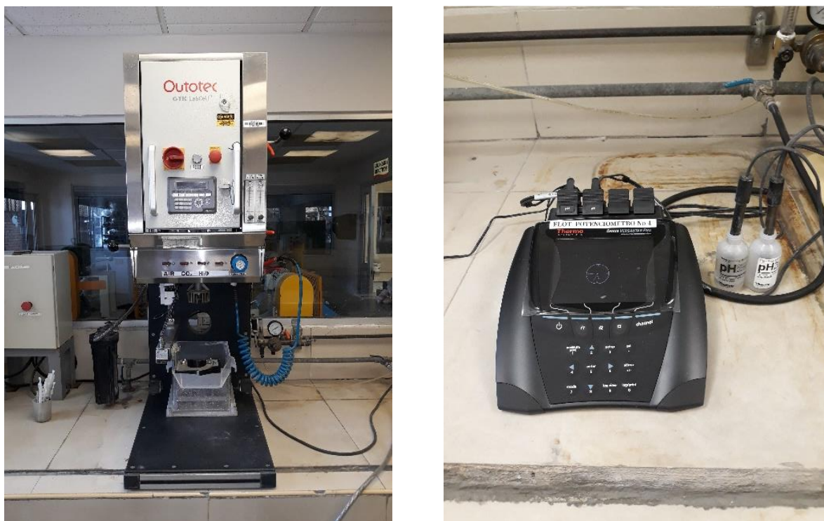
Figura 23. a) Celda de flotación Outotec y b) equipo para medición de pH y ORP Fisher
