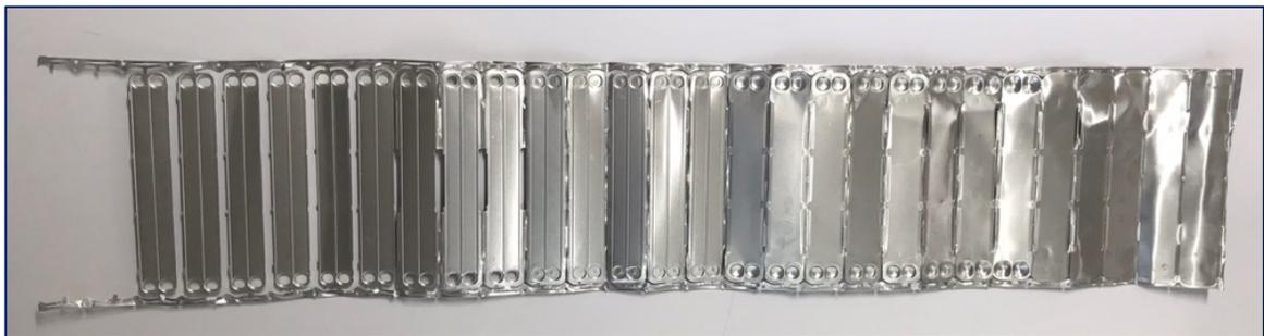
**Figura 19. Secuencia de formado para la producción de placas perforadas utilizadas en la fabricación de intercambiadores de calor.**
