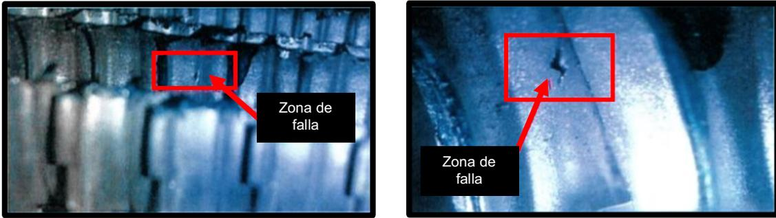
Figura 10. Agrietamiento en placas de un intercambiador de calor en un ensamble terminado.
