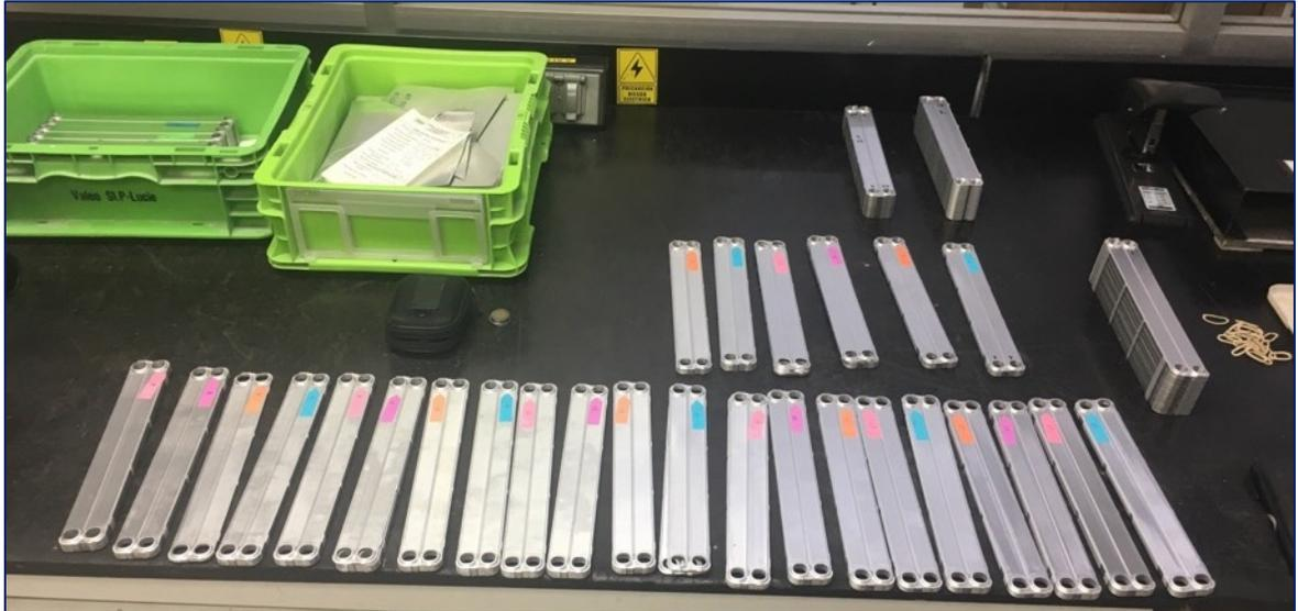
**Figura 20. Piezas troqueladas bajo distintas condiciones de estampado.**
