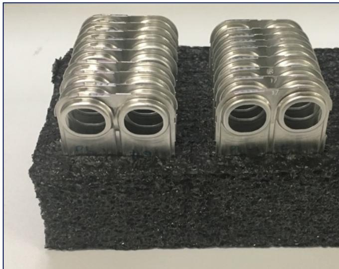
**Figura 23. Montaje de las placas perforadas para su análisis por tomografía de rayos-X.**
