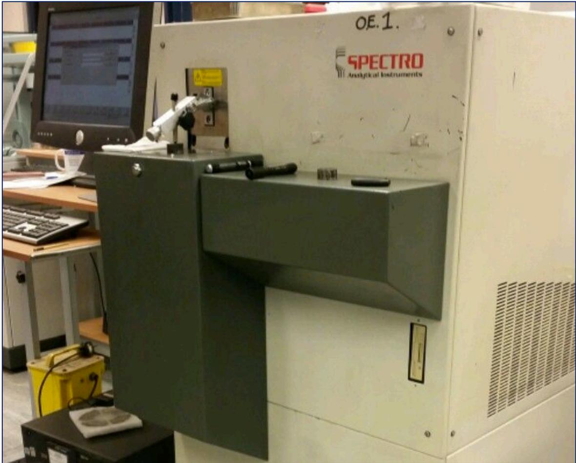
**Figura 21. Espectrómetro de emisión óptica Spectro Analytical Instruments M-8.**
