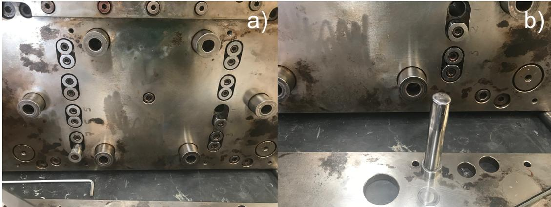
**Figura 58. a) Ajuste de los punzones del troquel de estampado, b) muestra de uno de los punzones utilizados.**
