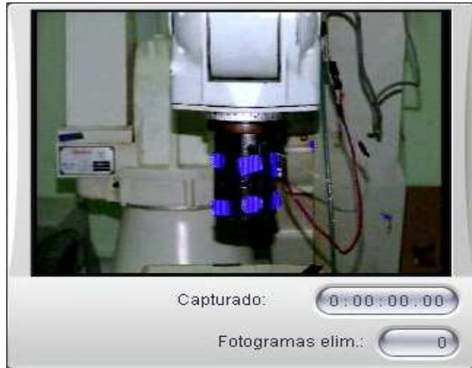
Figura 4.11: Resultado de la detección de marcas por umbralado
