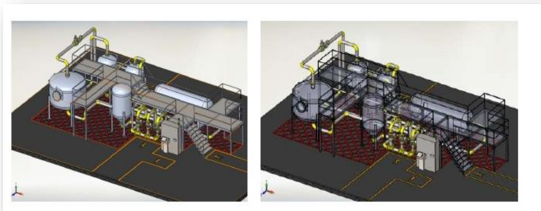
Fig. 2-1 Ensamble realizado en Solidworks.
