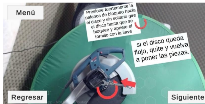
Figura 3.23. Cuarto paso para realizar el montaje.
