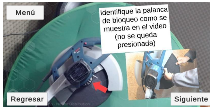
Figura 3.22. Tercer paso para realizar el montaje.
