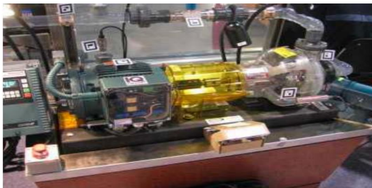
Figura 2.3. Prototipo de un sistema de bombeo con información obtenida con RA [79].
