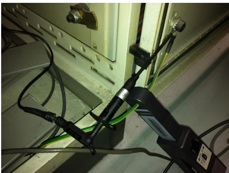
Figura 3.13 Sondas de prueba utilizadas para medición de voltaje y corriente en conductor de tierra de máquina de soldar.
