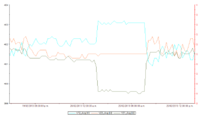
Fig. 1.2 Componamiento de la tensión (valores promedio rms).
