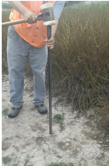
Figura 20. Muestreo vertical de sedimento con barra acanalada
