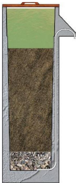
Figura 2.25 Principio de operación de filtro de flujo lento
