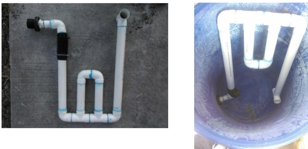
Figura 2.13 Sifón auto operante en el interior del Tanque de 200 litros
