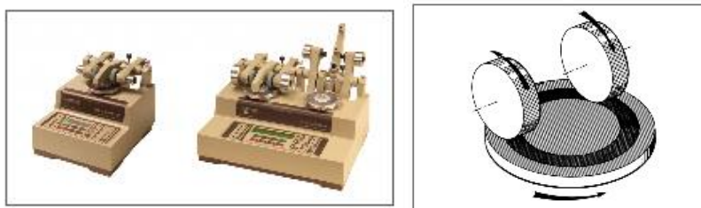
Figura 8: Máquina Taber para pruebas de abrasión. Fuente: Taber Industries
