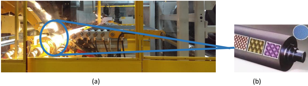
Figura 27: Estación de la máquina de estampado (a) y ejemplo de un rodillo grabado (b). Fuente: Empresa colaboradora.
