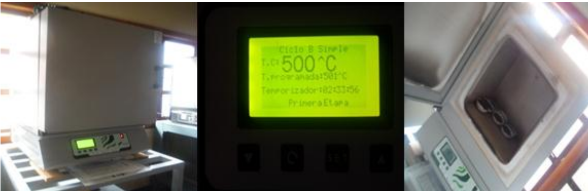
Figura 8. Carbonización de huesos a 500 °C en mufla marca Felisa modelo FE-363
