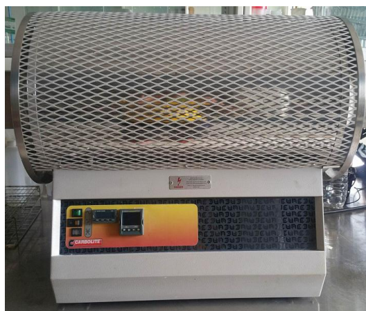
Figura 1. Horno tubular marca Carbolite, modelo CTF-1200°C, empleado para la pirólisis de los huesos de peces pleco
