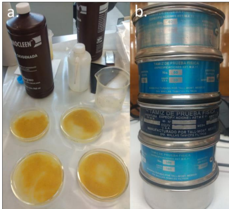
Figura 2. Elementos utilizados para el metodo de levigado; a. Agua oxigenada y b. Tamices para micropaleontología
