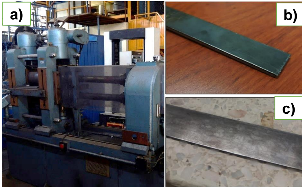
Figura 12. a) Molino de laminación HILLE HELICON MK4, b) acero laminado en caliente hasta 2.3 mm y c) laminado en frío hasta 1.0 mm.
