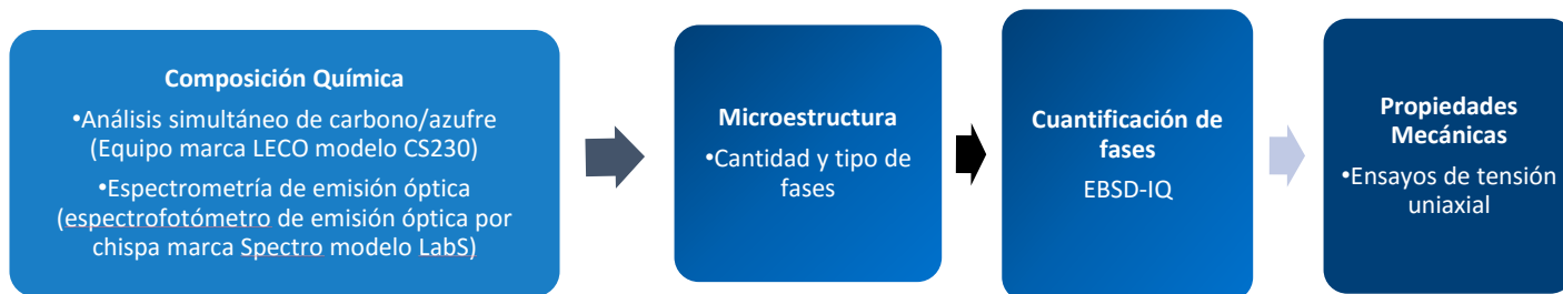
Figura 9. Diagrama de flujo de la caracterización del material.
