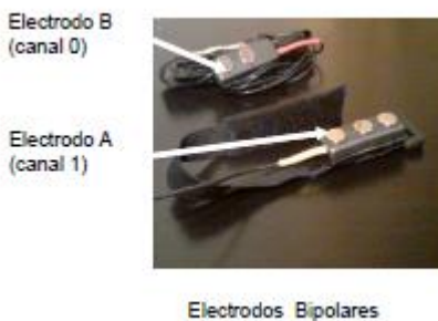
Figura 4. Electrodos bipolares superficiales con alineación de plata
