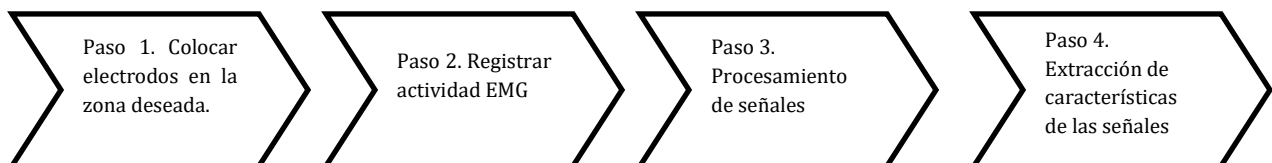
Figura 12. Método general para procesar la señal EMG
