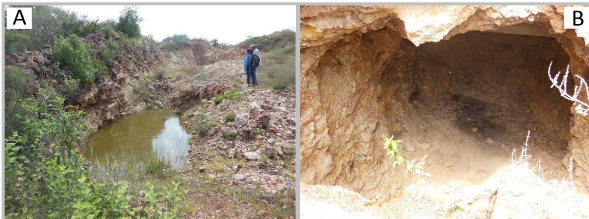
Figura 5.18. Fotografías mostrando obras mineras en la localidad Rancho Viejo I. A) Obra minera desarrollada en dirección de la traza de la falla Rancho Viejo I y encajonada en el Intrusivo Palo Verde (Ppv), de la cual fue extraída fluorita. B) Socavón labrado sobre la traza de falla Rancho Viejo I, con las mismas características litológicas.
