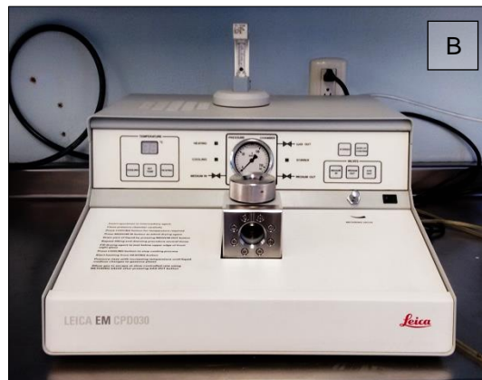
Figura 19. A) Diagrama de fase de CO 2 B) Equipo Leica EM CPD030 para realizar punto crítico de secado.
