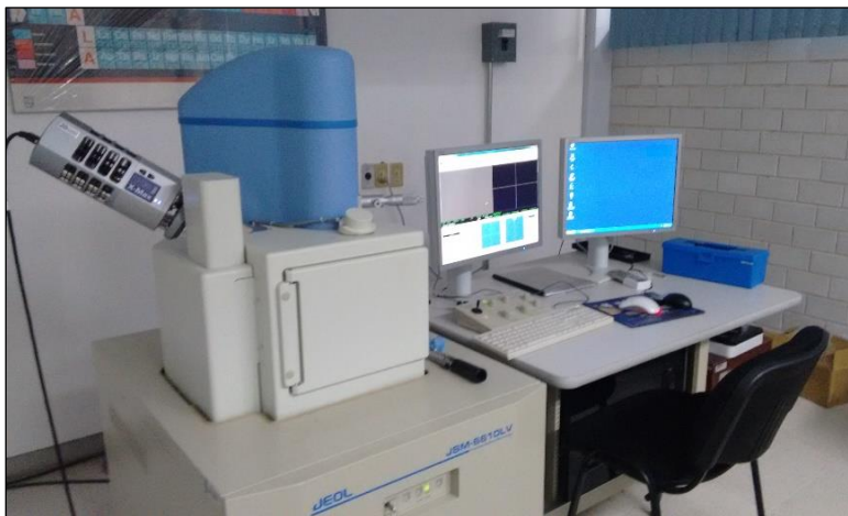
Figura 21. Microscopio electrónico de barrido Jeol modelo JSM-6610LV y Phillips modelo XL30 (no mostrado este último).
