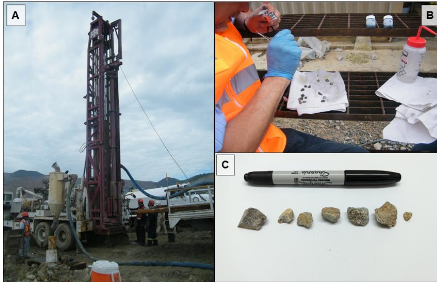
Figura 17. Muestreo de material que compone terreros de biolixiviación en la mina “La Caridad”, Sonora. A) Barrenación y extracción de las muestras a diferente profundidad; B) Selección de piezas minerales; C) Algunas de las muestras minerales extraídas de los terreros, se observan las diferentes dimensiones que presentan (Fotografías obtenidas por Antonio Aragón y Daniel Pacheco).
