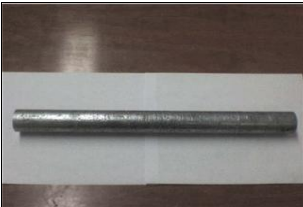
Figura 2.2 Barra de Zinalco obtenida por colada continua.
