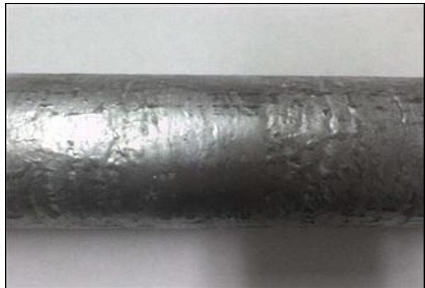
Figura 2.3 Detalle de los defectos superficiales de la barra de Zinalco.
