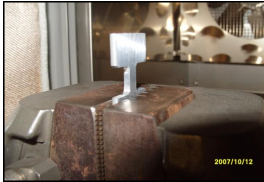
Figura 2.11 Colocación de la probeta en la máquina de tensión universal para realizar los ensayos de deformación superplástica.
