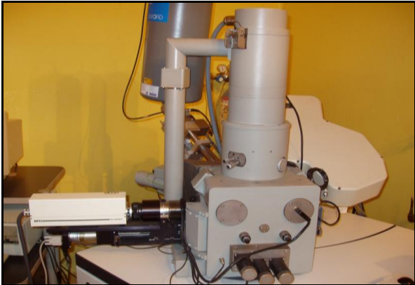
Figura 2.14 MEB utilizado para la técnica de OIM-EBSD.
