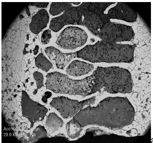
Figura 3.21 (a) Imagen obtenida por MEB del colágeno hidrolizado al 10% en hueso sintético. (b) Curva de Esfuerzo-Deformación del ensayo en compresión uniaxial del hueso sintético consolidado con colágeno hidrolizado.
