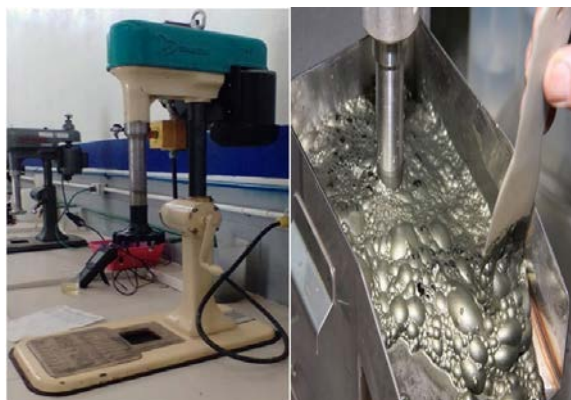
Figura 28. Celda de flotación de laboratorio tipo Denver marca Metso®
