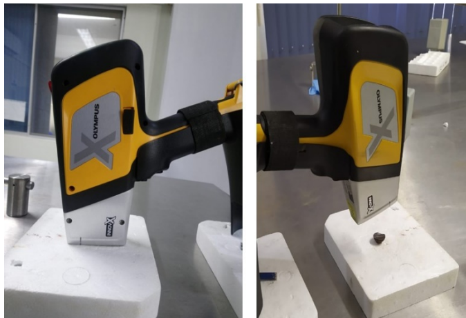
Figura 68. Forma de análisis en el equipo de fluorescencia de rayos X
