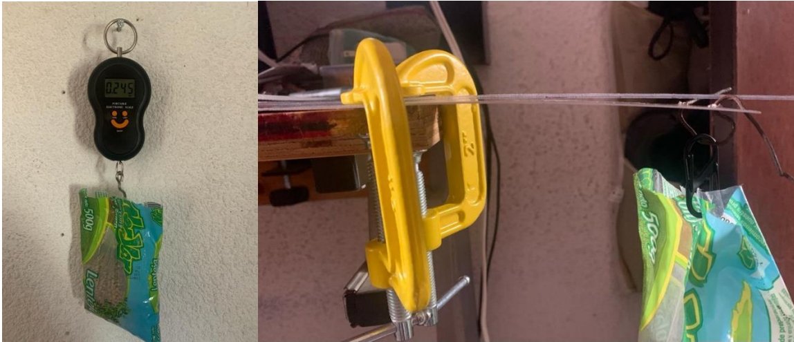
Figura 3. 2: Viga sometida a carga conocida para caracterizar el módulo de elasticidad del eje central.
