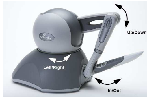
Figura D.1: Macro-movimientos del dispositivo háptico PHANTOM Omni (Sensable Technologies, www.sensable.com , 2011).
