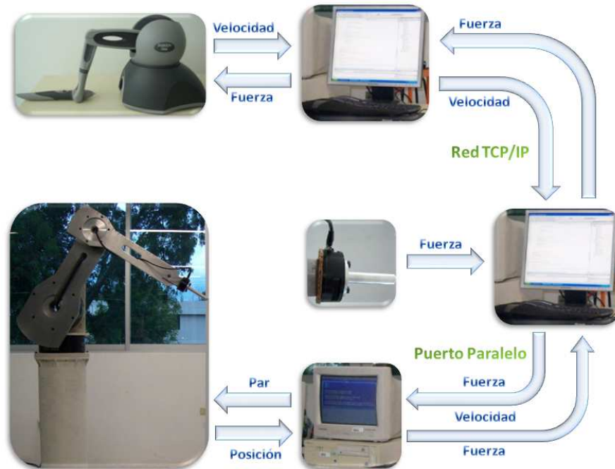
Figura 3.34: Diagrama de bloques del sistema de teleoperación bilateral.
