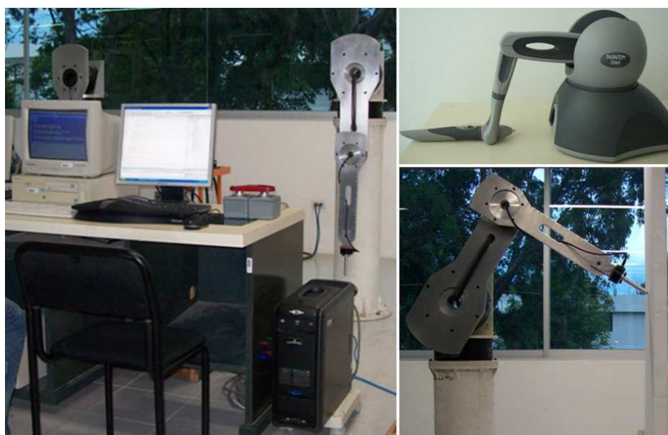
Figura 3.33: Plataforma experimental para teleoperación bilateral. Laboratorio de Robótica, Facultad de Ciencias de la Electrónica, Benemérita Universidad Autónoma de Puebla.
