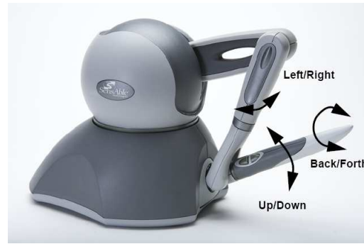
Figura D.2: Micro-movimientos del dispositivo háptico PHANTOM Omni (Sensable Technologies, www.sensable.com, 2011).
