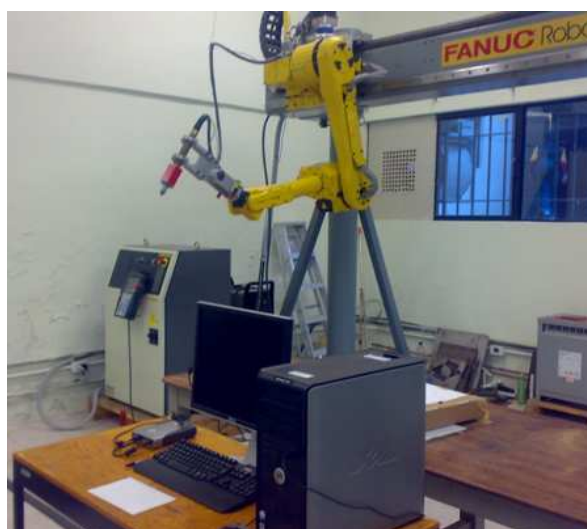
Figura 2.5: Robot manipulador FANUC M-16iB 20T. Laboratorio de Robótica, Facultad de Ingeniería, Universidad Autónoma de San Luis Potosí.
