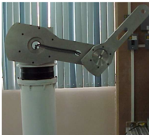
Figura 1.2: Robot manipulador de transmisión directa de dos grados de libertad. Laboratorio de Robótica, Facultad de Ciencias de la Electrónica, Benemérita Universidad Autónoma de Puebla.
