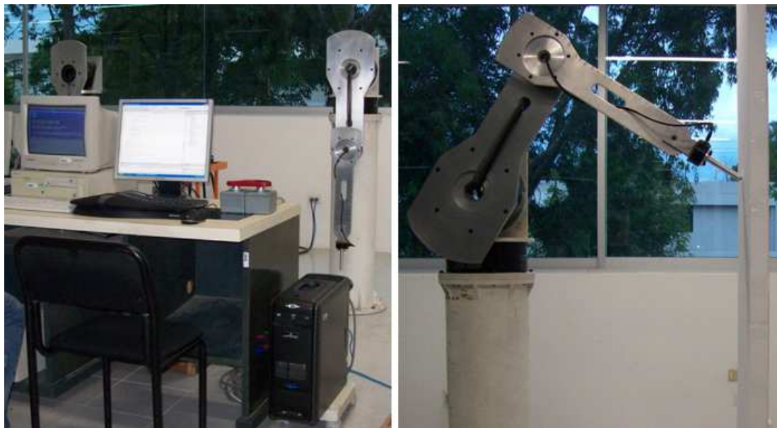
Figura 1.8: Plataforma experimental de transmisión directa. Laboratorio de Robótica, Facultad de Ciencias de la Electrónica, Benemérita Universidad Autónoma de Puebla.
