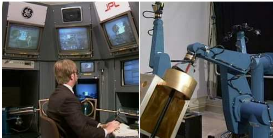
Figura 2.1: Sistema de teleoperación para demostrar el cambio de una unidad de remplazo orbital (NASA Jet Propulsion Laboratory, www-robotics.jpl.nasa.gov , 2011).
