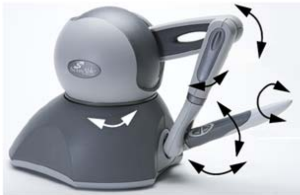
Figura 1.1 Rotación de la base y en eslabones
