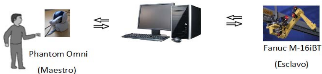
Figura 3.1 Elementos que componen el proceso de teleoperación
