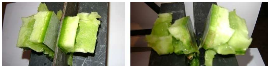
Figura 4.8. Corte de la cactácea con un ángulo de la cuchilla mayor a 38°.
