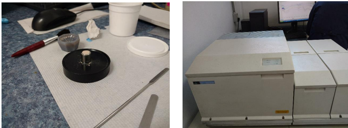
Figura 13. (Izquierda) sólido montado en un pin cilíndrico de acero al carbón, (derecha) Espectroscopio de IR marca Perkin Elmer modelo Spectrum GX.
