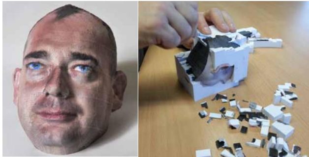
Figura 2.29. Prototipos de papel elaborados por SDL-MCOR.
