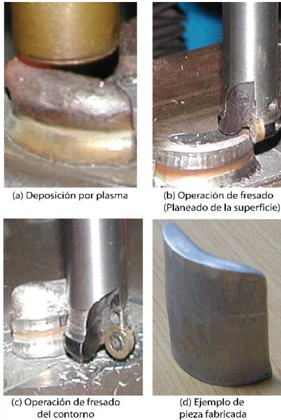
Figura 2.143. Alabe fabricada por medio de HPDM [212].
