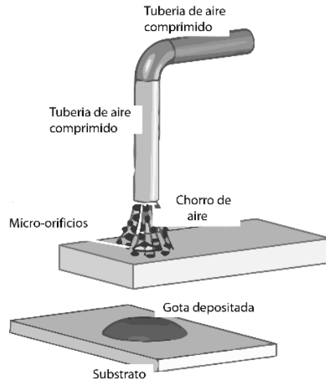
Figura 2.55. Principio del proceso HVJ.
