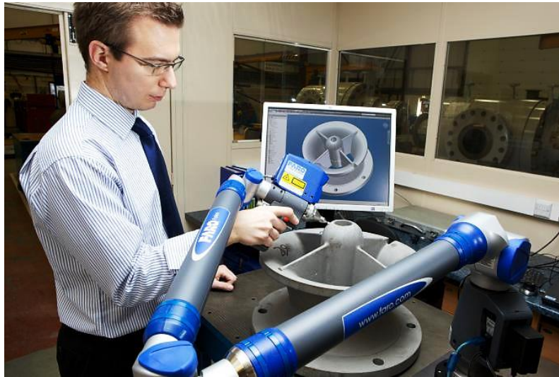
Figura 1.3. Ingeniería inversa de un objeto 3D (Escaneo tridimensional).
