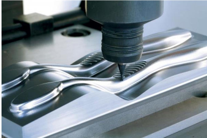
Figura 1.1. Maquinado de alta velocidad de una superficie, [7].
