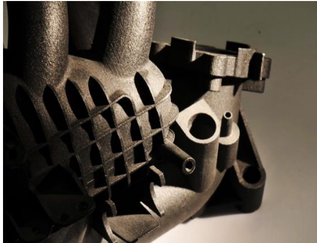
Figura 2.83. Múltiple de automóvil fabricado por SLS [169].
