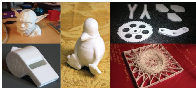
Figura 2.31. Ejemplo de modelos generados con el sistema FDM [101].
