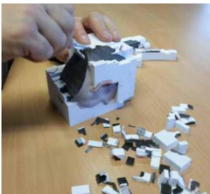
Figura 4.2. Remoción de las estructuras de soporte de un proceso de apilado.
