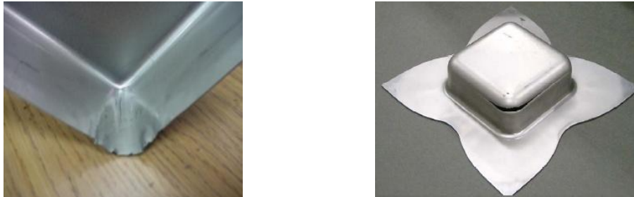
Figura 2.3. Principales defectos en las piezas rectangulares embutidas (arrugas y fisuras).
