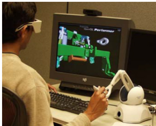
Figura 2.14. Sistema de ensamble virtual háptico propuesto por Seth, Su y Vance (2005) [84].
