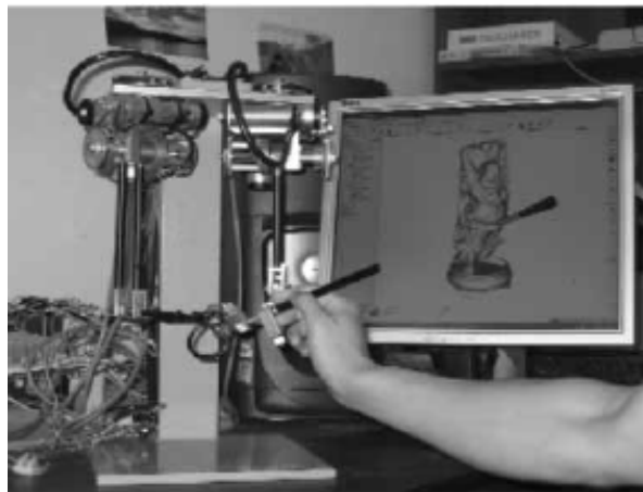
Figura 2.5. Sistema háptico para planeación de manufactura y prototipado desarrollado por Ren, et al. (2006) [43].
