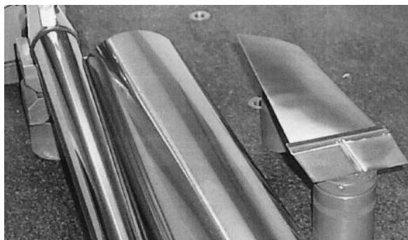
Fig. 2. 8 Configuración para las mediciones de álabes de turbina.
