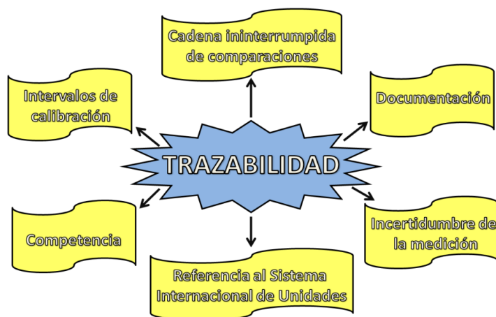
Fig. 2. 7 Elementos esenciales de la trazabilidad.
