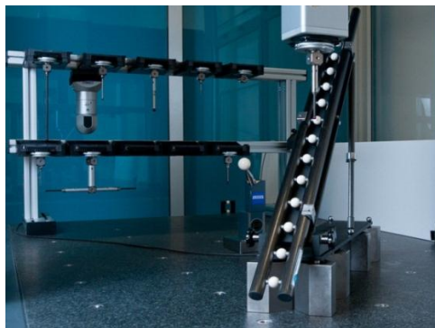
Fig. 2.17 Barra de esferas con 45° de inclinación.
