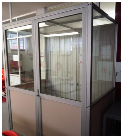
Fig. 4. 3 Cuarto de medición independiente con doble puerta de acceso.
