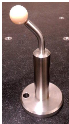
Fig. 4. 8 Esfera de referencia de 25 mm.
