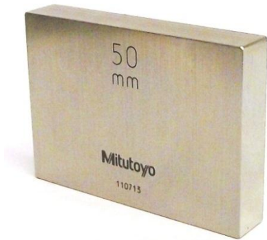
Fig. 4. 5 Bloque Patrón de 50mm.
