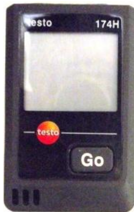
Fig. 4. 2 Sensor de temperatura "Data Logger TESTO 174H".
