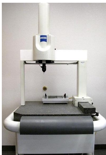
Fig. 4. 4 MMC Modelo Vista 1620-14 DCC.
