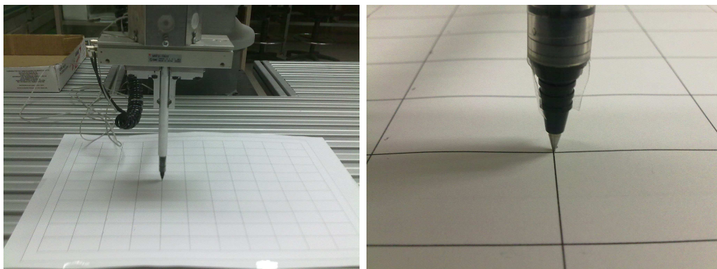
Figura 1: Estudio de error de posicionamiento del robot realizada en el patrón cuadrículado.
