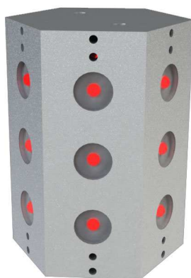
Figura 4.4: Diseño de la estructura de las marcas visuales
