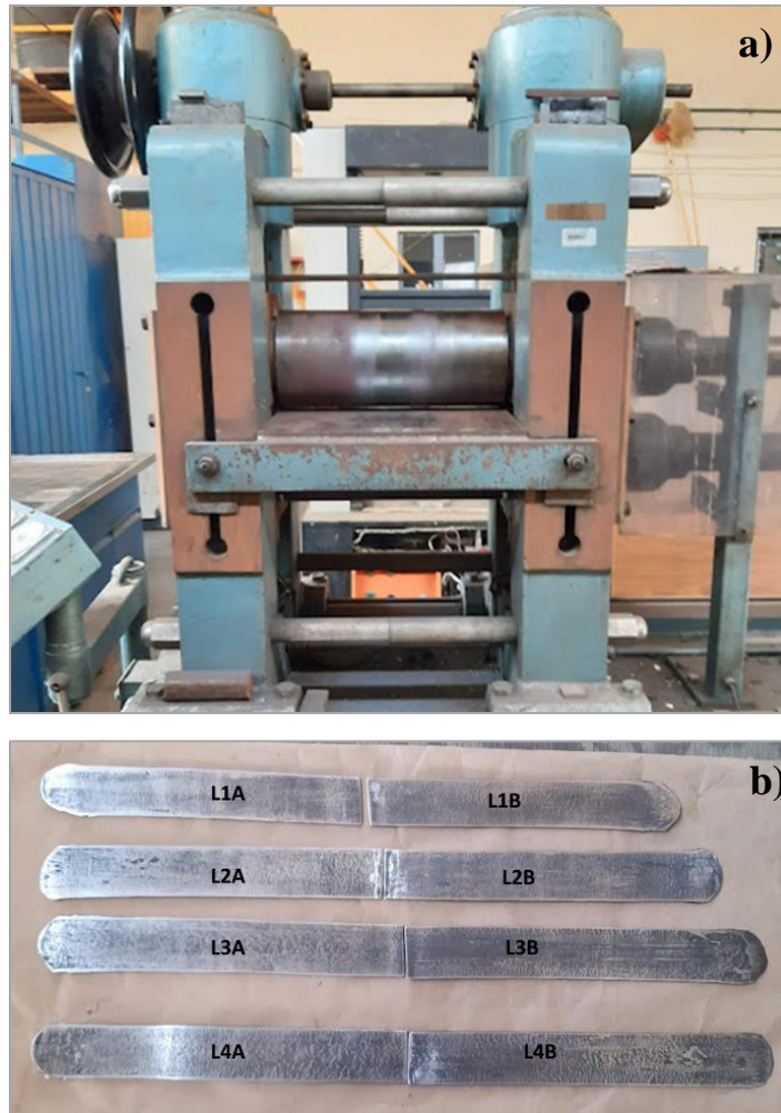
Figura 12. a) Molino de laminación HILLE HELICON MK4, b) probetas laminadas de espesor A:1.5 mm y B: 1.0 mm.
