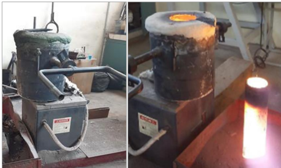
Figura 10. Horno de inducción Power-Trak 35-96.
