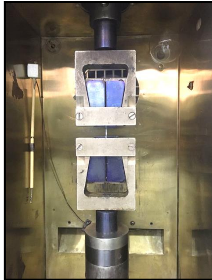
Figura 2.5 Máquina universal con horno integrado para ensayo de tensión
