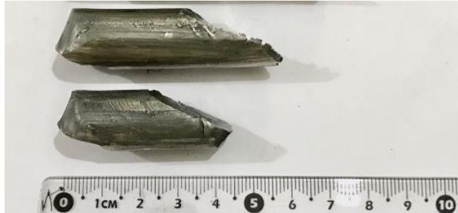
Figura 2.5 Probetas con 3 (superior) y 5 pasos de *ECAP* (inferior).
