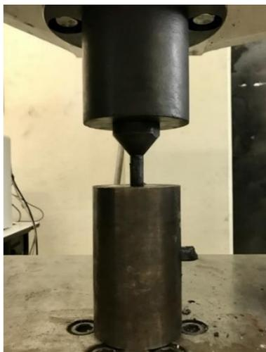
Figura 2.4 Proceso de *ECAP*, llevado a cabo con el uso de una máquina de ensayos universales y con una velocidad del cabezal de 6 mm/min. Marca: Shimadzu Modelo:UH-600KNI.
