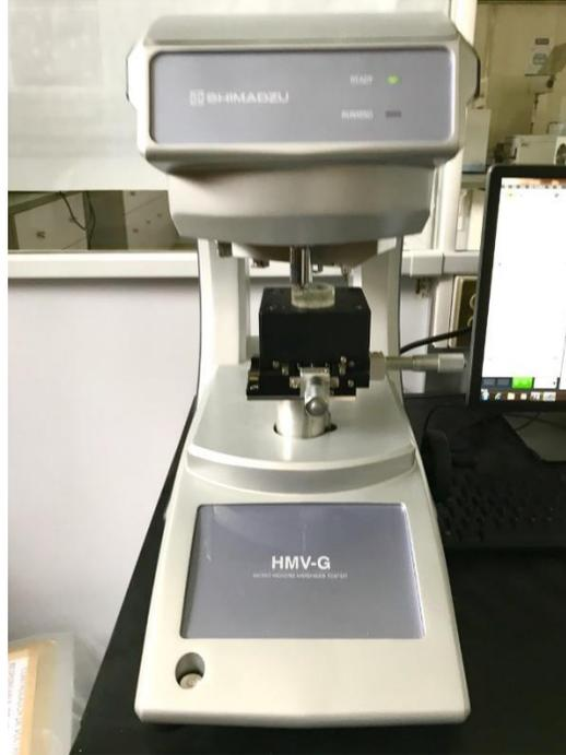
Figura 2.8 Equipo para microdureza. Marca: *Shimadzu* Modelo: HMV-G.
