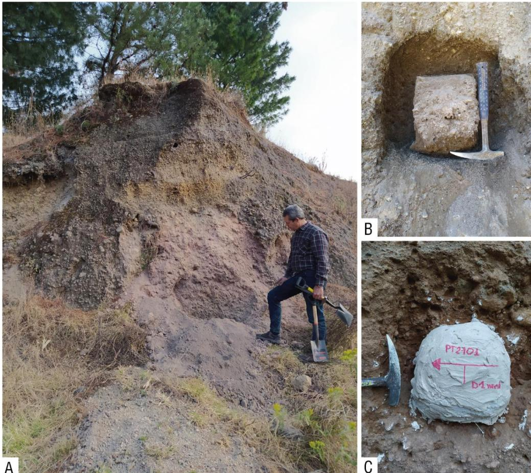
Figura 3.27. Técnica de muestreo. A. Preparación del afloramiento previo al muestreo. B. Cuboide de 10 cm<sup>3</sup>. C. Cobertura de yeso y Orientación de la Muestra.
