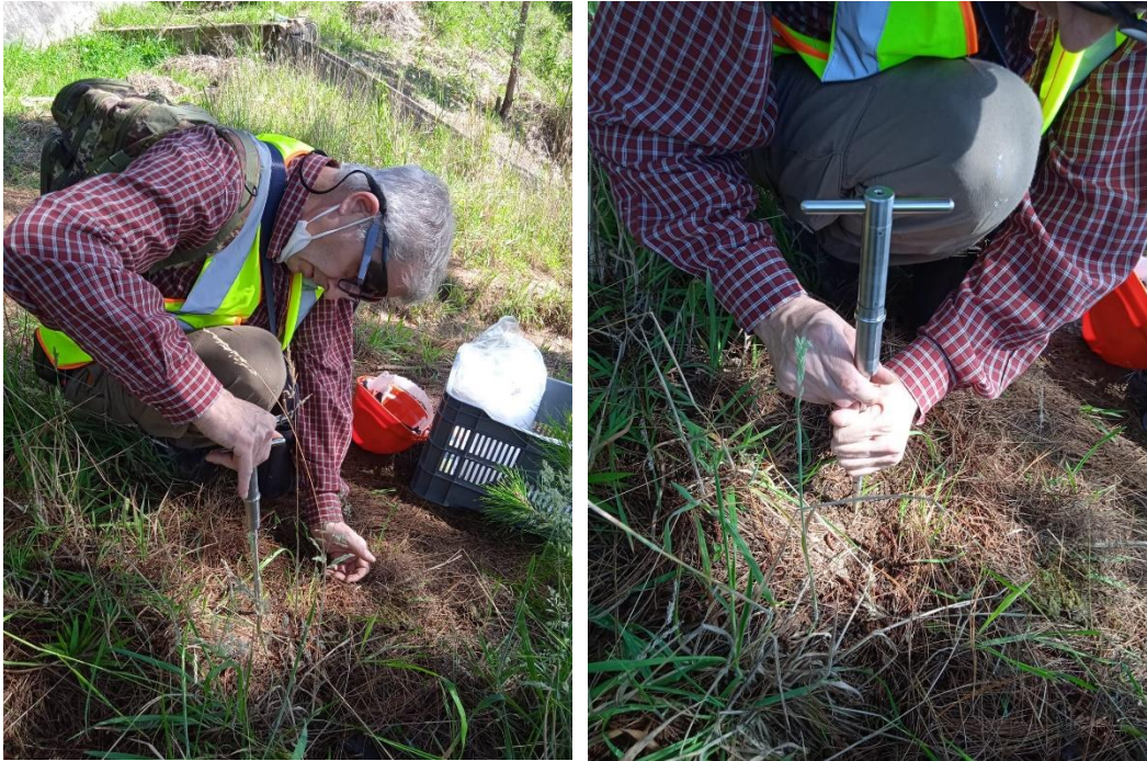
Figura 4.9 y 4.10: Pruebas de resistencia al corte con la veleta en La Aurora
