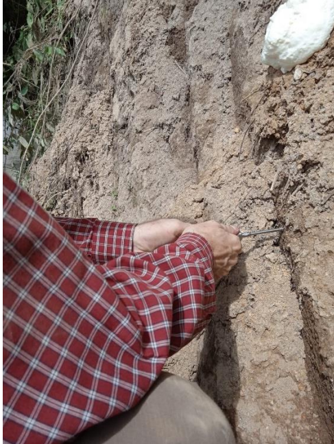
Figura 4.5: Ensayo con el penetrómetro en Xoloco
