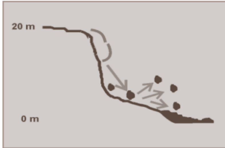
Figura 3.1: Caídos y derrumbes (Fascículo Inestabilidad de laderas, 2008)
