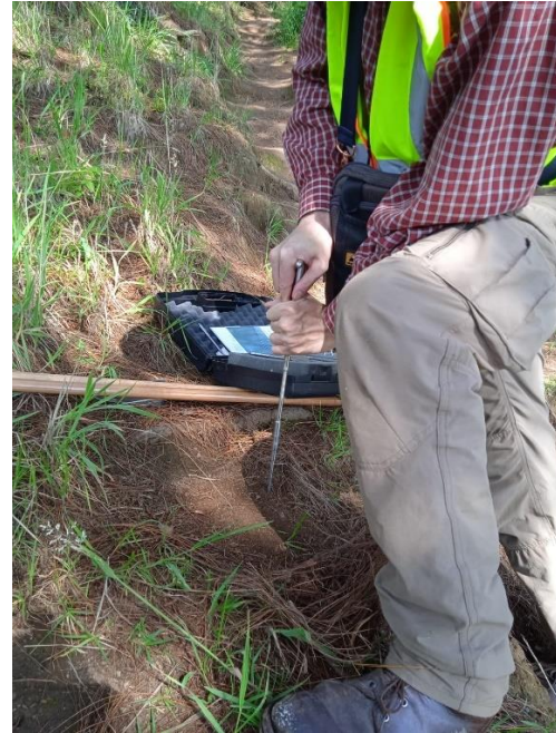
Figura 4.6: Ensayo con el penetrómetro en La Aurora
