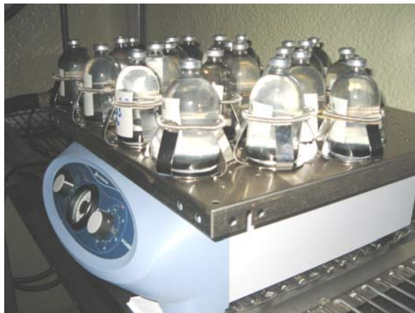
Fotografía 7.2 Sistema de agitación orbital para evaluar las cinéticas microbianas con el consorcio P1.
