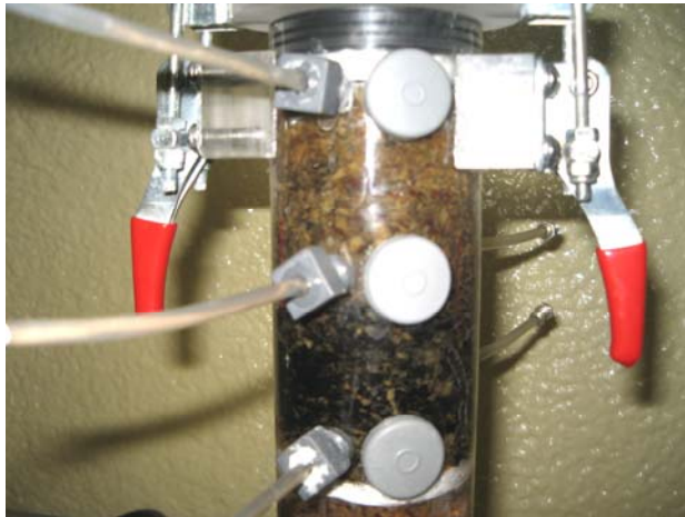
Fotografía 7.4 Zona biológica de la columna, asentamiento de la biomasa principalmente en la zona media y baja, ocasionando que el potencial es más bajo que en la zona superior de esta sección.
