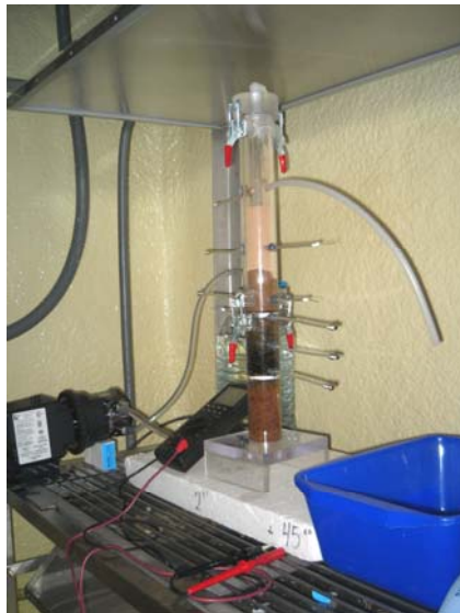
Fotografía 7.5 Ensamble de la columna con cada una de sus secciones, zona de estabilización (suelo), zona biológica (bacterias), zona de distribución de flujo (aserrín), multímetro, bomba y depósito para recuperar la solución al final de la estabilización.
