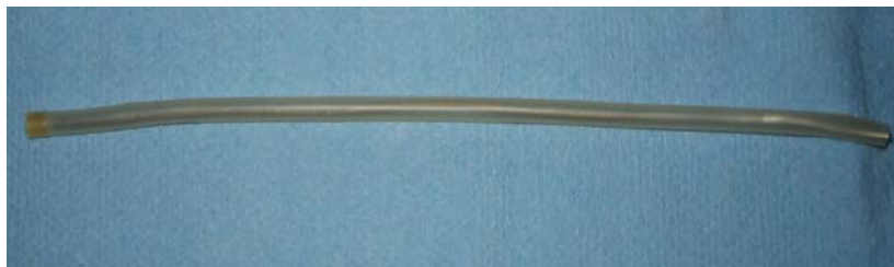
Fotografía 5.2 Electrodo de referencia Ag/AgCl, colocado dentro del cuerpo de electrodo conteniendo el Vycor® en el extremo izquierdo.
