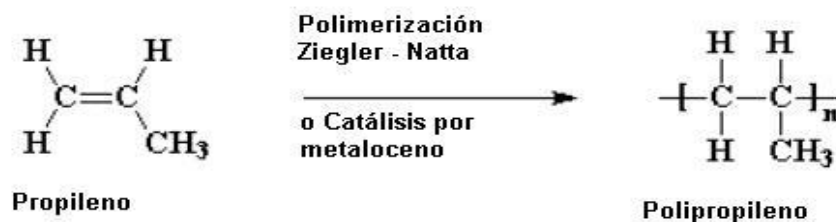
Ilustración 3 Descripción gráfica de la reacción de polimerización para generar polipropileno (Fuente: Tecnologiadelosplasticos.blogspot.com )
