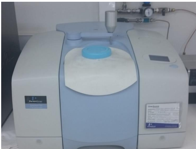
Ilustración 15 Equipo utilizado para la medición de los espectros por infrarrojo a las muestras de PP extruidas, para la identificación del grupo carbonilo (FTIR) Fuente: Elaboración empresa.
