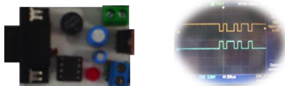
Figura 32. Tarjeta de conversión RS-232 a RS-485
