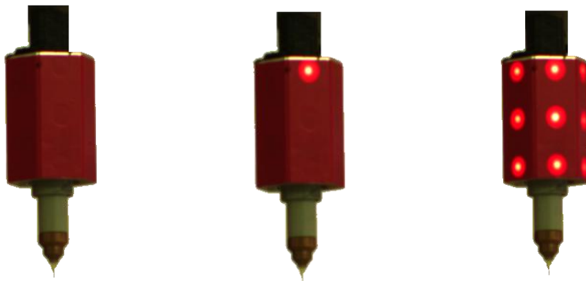
Figura 7. Marcas visuales artificiales colocadas alrededor de la herramienta de corte
