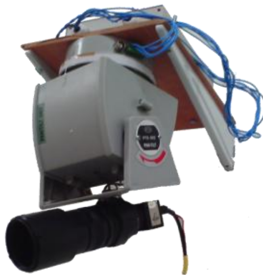
Figura 4. Cámara montada en una plataforma giratoria
