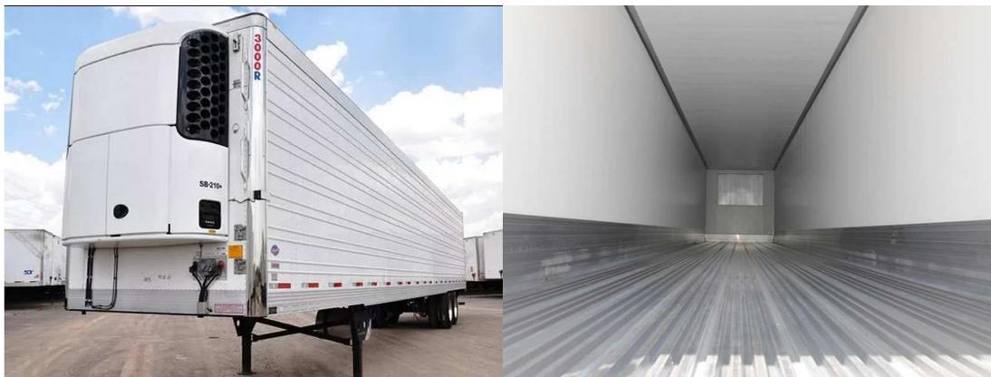
*Figura 15: Caja refrigerada S2 por el exterior mostrando equipo de congelación y el interior con aislamiento (Utility Trailers de México, 2019).*
