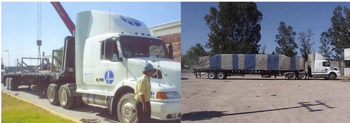
**Figura 13:** *Plataforma T3S2 sin carga y cargada con lona puesta (fotos propias).*
