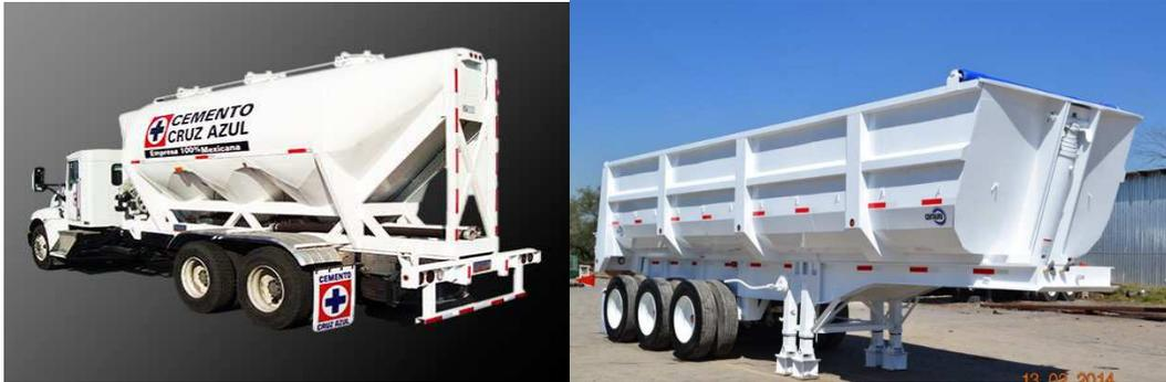
**Figura 10: Tolva cementera C3 (Remolques Cruz SA de CV, 2019) y tolva de volteo arenera S3 (Tanques y Remolque Centauro, SA de CV, 2019).**
