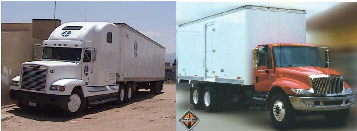
**Figura 14: Caja seca T3S2 (foto propia) y caja seca C3 (Daimler vehículos comerciales México, S. de R.L. de C.V., 2017).**
