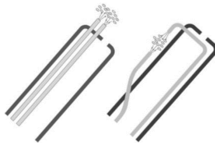
Figura 17. Oxímetros intravenosos de fibra óptica de reflexión (izquierda) y transmisión (derecha). Las fibras ópticas se encuentran en gris y la pared del catéter en negro (imagen tomada de [31]).
