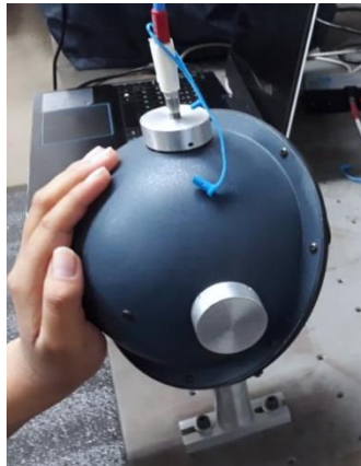
Figura 37. Medición de reflectancia difusa con esfera integradora.
