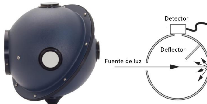
Figura 33. Esfera integradora Newport 819C-SF-6 (imagen tomada y adaptada de[84]).
