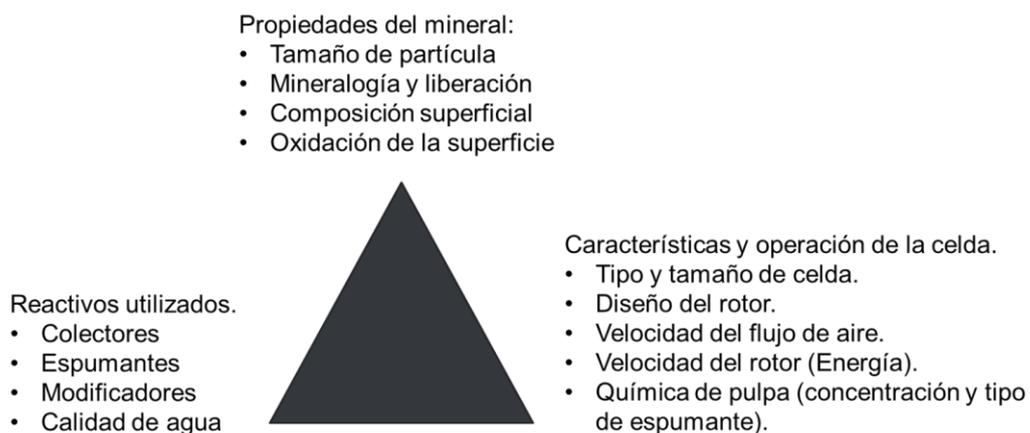
**Figura 4.** Variables de un proceso de flotación de minerales por espuma.
