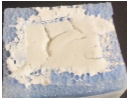
Figura 2.9. HA agrietada en moldes pequeños.
