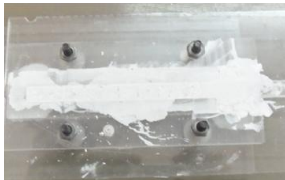
Figura 2.10. Moldes completamente sellados y rellenos con pasta de HA.
