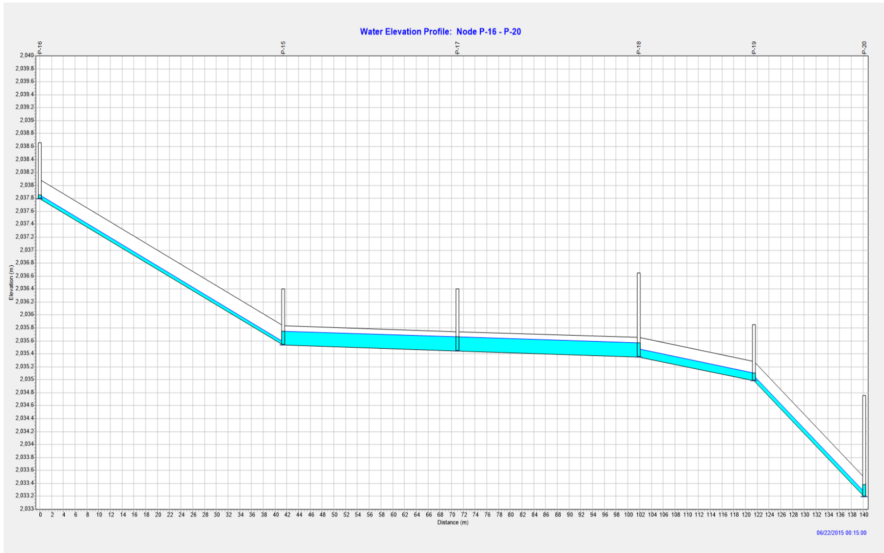
Figura 4.33 Perfil topográfico del SAP. Tramo P-16 a P-20. Unidades metros.
