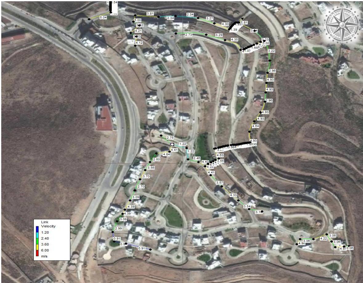
Figura 4.30 Resultados del SWMM. Velocidad del agua dentro del SAP. Unidades en m/s.
