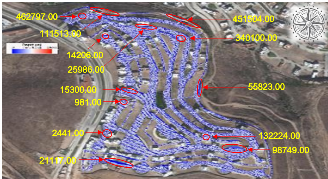
Figura 3.16 Identificación y cuantificación de la acumulación de agua pluvial.
