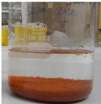
Figura 46. Resultado final del proceso de centrifugación-coagulación-floculación en los efluentes obtenidos de la purificación de biodiesel producido por diferentes materias primas.
